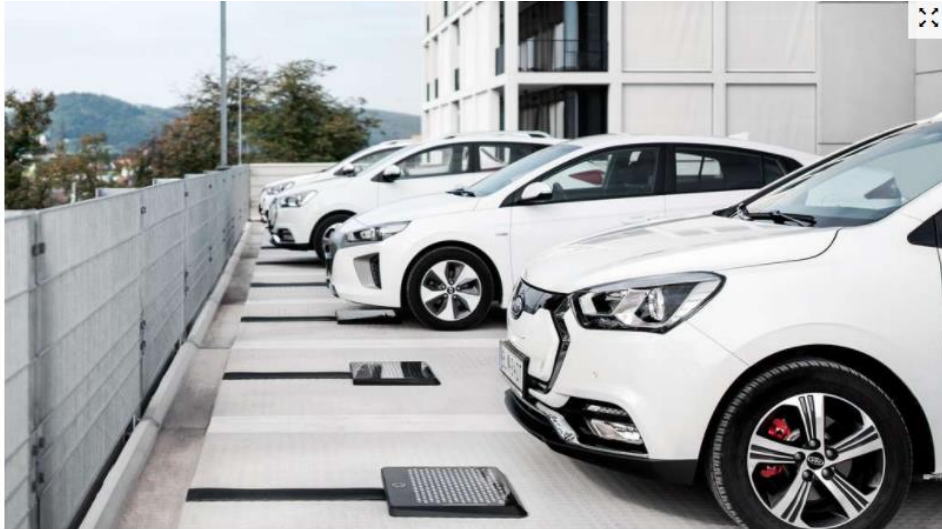
„Park & Charge“: In speziellen Parkbuchten soll Laden von Stromern bald auch ohne Kabel möglich sein. © Easelink
