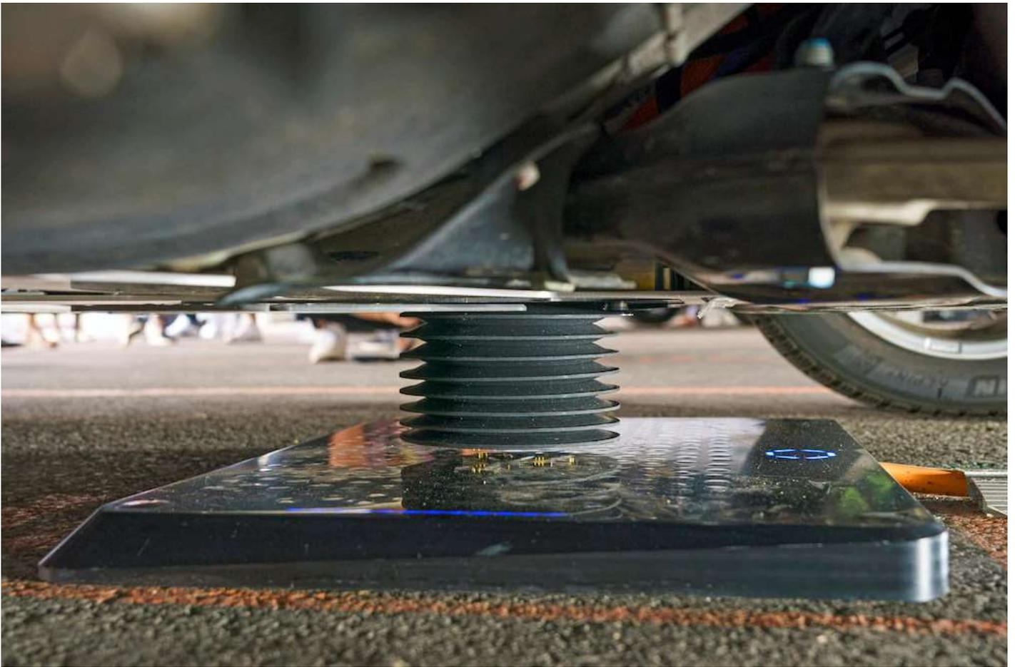
Nach dem Parken senkt sich der Charging Connector am Unterboden des E-Autos bis zum Lade-Pad herab.
