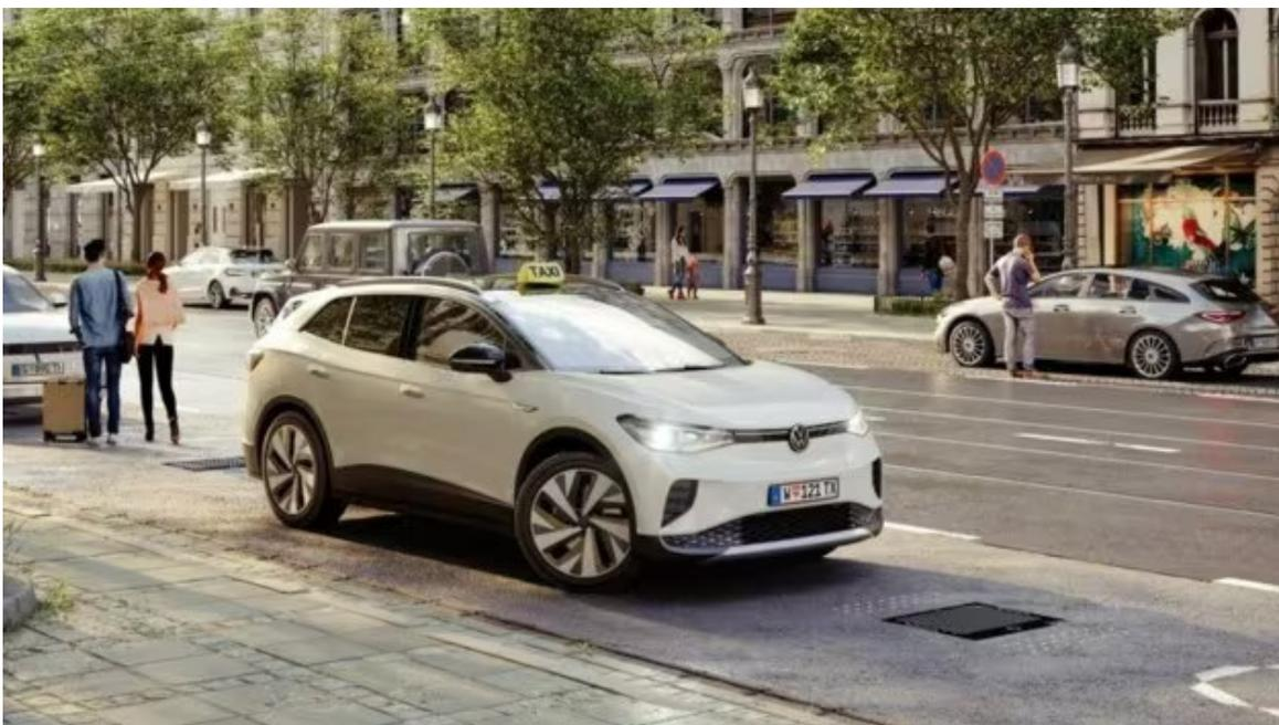
Über Ladeplatten im Boden werden die Fahrzeuge kabellos geladen.
