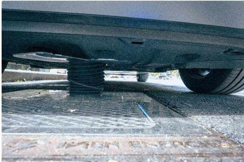
Was ist diese **Matrix Charging Technologie**? Anstatt das E-Auto mit einem Kabel an die Ladestelle anzustecken, wird das Fahrzeug, ausgestattet mit einem sogenannten **Connector am Unterboden**, per Knopfdruck **mit einer Ladeplatte am Taxistandplatz verbunden**. Mit diesem automatisierten Laden direkt an den Standplätzen werden die eTaxis automatisch aufgeladen, ohne dass man das Fahrzeug verlassen oder eine E-Tankstelle aufsuchen muss - für einen **flüssigen eTaxi-Betrieb** unerlässlich.
